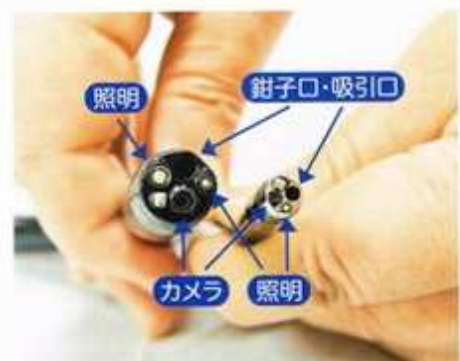
挿入部の先端。左が大腸用(肛門から挿入)、右が胃用(鼻から挿入)
